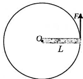
12- قضيب فلزي منتظم، كُتلتُه ( $M$ ) وطوله ( $L$ )، يتحرك حركةً دوارةً حول محور ثابت عموديٌّ على مستوى الدوران، يمُرُ في إحدى نهايَتِي القضيب عند النقطة ( $O$ )؛ بتأثير قوة مماسية ( $F$ ) ثابتةٍ في المقدار، كما هو موضح في الشكل المجاور.
