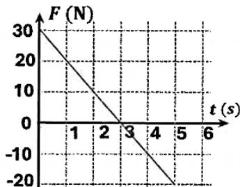
3- يُبيّن الشكل المجاور التمثيل البياني للقوة المؤثرة في جسم ساكن كُتلته (5 kg) وزمن تأثيرها. مقدار سرعة الجسم النهائيّة بوحدة (m/s) يساوي:
