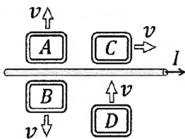
26- يبين الشكل المجاور أربع محاولات مختلفة لتوليد تيار كهربائي حتى في الملفات (A,B,C,D) التي تتحرك في المجال المغناطيسي لموصل مستقيم يسري فيه تيار. الملفان اللذان يتولد فيما بينهما التيار الكهربائي الذي بالاتجاه نفسه هما:
